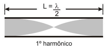
O comprimento do tubo é igual a meio comprimento de onda.
