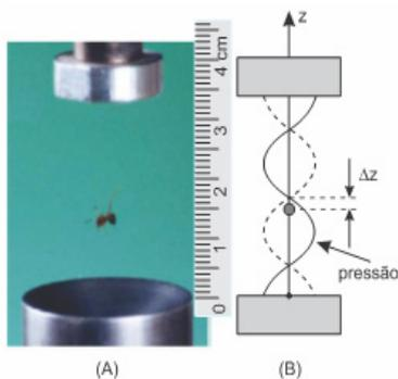
a. As frequências de ressonância acústica entre duas placas, ou num tubo fechado nas duas extremidades, são dadas por  $f_n = \frac{nv}{2L}$ , sendo L a distância entre as placas,  $v = 340$  m/s a velocidade do som no ar, e um número inteiro positivo e não nulo que designa o modo. Qual é a frequência do modo ilustrado na figura B?
