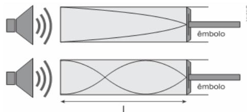
Aparecem regiões de amplitude máxima (os ventres) intercalados por regiões de amplitude mínima (os nós). Devido às condições desse experimento, para um tubo de comprimento  $l$ , com uma extremidade aberta e a outra fechada, as frequências de ressonância, ou frequências das ondas estacionárias observadas, correspondem aos comprimentos de onda dados por:
