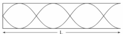
O valor do deslocamento das moléculas de ar na posição de um dos ventres dentro do tubo
