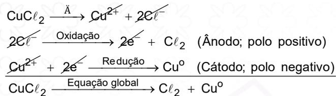
**Conclusão:** o cobre metálico ( $\text{Cu}^0$ ) é produzido no cátodo (polo negativo).
