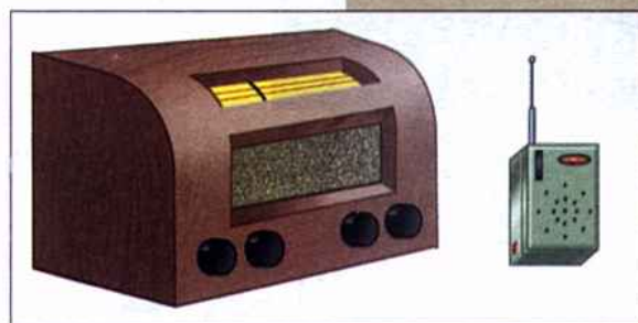
Fig. 21-26: os rádios transistorizados são muito menores do que os antigos rádios a válvula.
