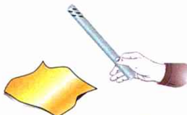
Fig. 17-4: Ilustração esquemática. Quando uma barra de borracha é atritada com lã, a barra fica eletrizada negativamente.
