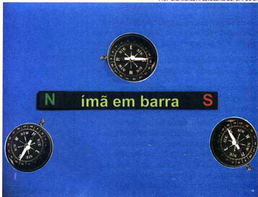
A agulha magnética indica, em cada posição, a direção e o sentido do campo magnético criado pelo ímã.
