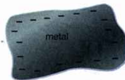
Fig. 18-20: Ilustração esquemática. Os elétrons livres adquiridos pelo condutor se distribuem em sua superfície.
