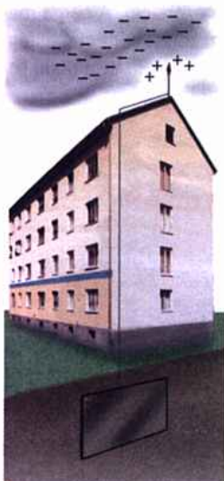
Fig. 18-32: Ilustração esquemática. O pára-raios exerce sua ação protetora contra os danos causados pelos raios.
