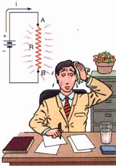
Fig. 20-34: Ao passar em uma resistência as cargas elétricas perdem energia elétrica que se transforma totalmente em calor. Este fenômeno é denominado efeito Joule.
