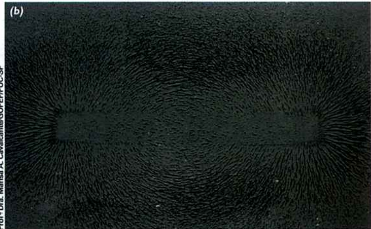
Fig. 22-12: Esquema das linhas de indução do campo magnético criado por um ímã em forma de barra.
