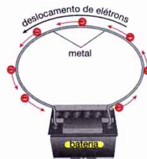
Fig. 17-8: Ilustração esquemática. Quando os pólos de uma bateria são ligados por meio de um fio metálico, os elétrons livres no interior do fio entram em movimento.
