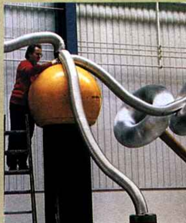
Fig. 19-21: A foto mostra um técnico da Siemens, conhecida empresa alemã de produtos elétricos, testando cabos que serão usados na transmissão de energia elétrica a altas voltagens. Estas condições são obtidas, no laboratório da empresa, usando-se um grande gerador de Van de Graaff, cuja esfera de cor amarela é facilmente identificada na figura.
