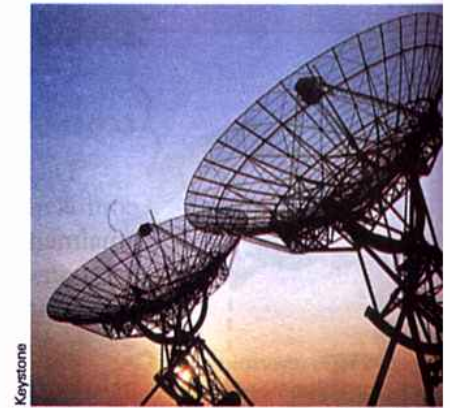
Antenas de transmissão e recepção de microondas de uma estação de comunicação por satélites.
