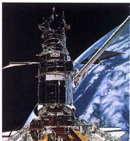
Fig. 25-8: O telescópio espacial de Hubble, da NASA (nome dado em homenagem ao astrônomo que conseguiu perceber que o universo está em expansão). O Hubble foi lançado em abril de 1990, planejado para permanecer em órbita durante 20 anos, realizando no espaço observações óticas e ultravioletas, visando fornecer dados às pesquisas realizadas pelos astrofísicos.
