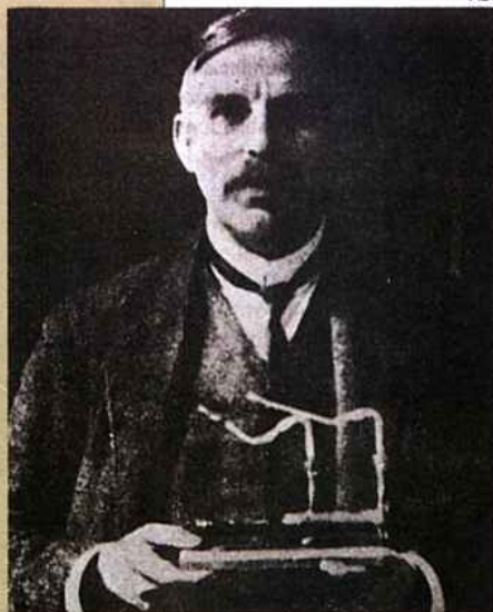
Fig. I: Rutherford, tendo em suas mãos o aparelho por ele planejado, com o qual conseguiu obter a desintegração de núcleos de nitrogênio, bombardeando-os com partículas \alpha (não aceleradas, emitidas espontaneamente por elementos radioativos).
