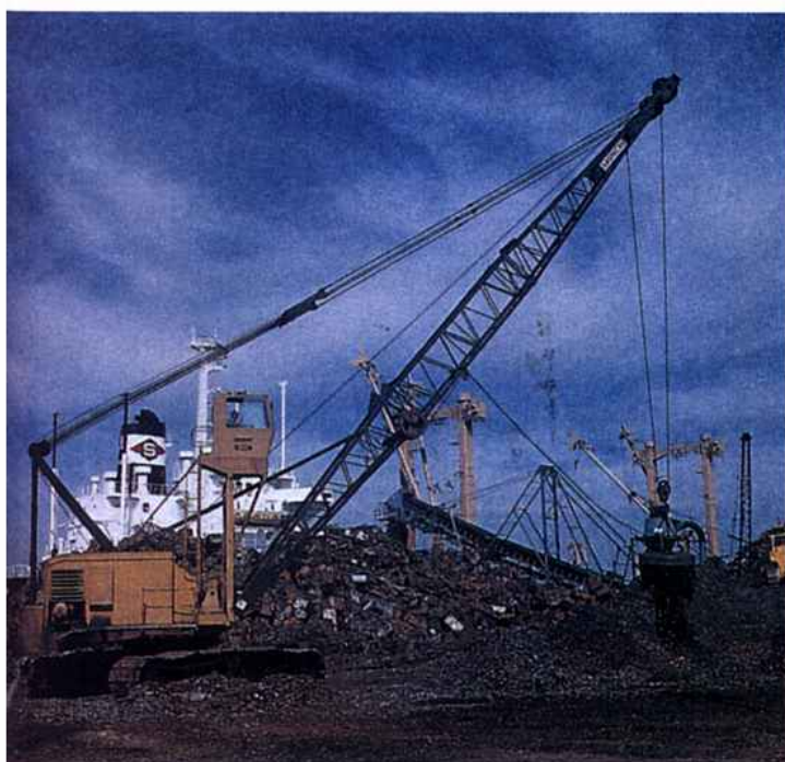
Fig. 23-19: Um guindaste de eletroímã pode transportar cargas muito pesadas.
