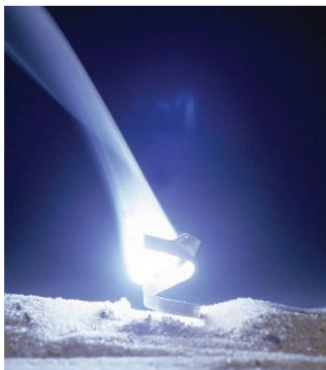
Fig. 1 Tira fina de magnésio sendo queimada, produzindo o \text{MgO} e liberando uma luz forte e bem brilhante, como em flashes fotográficos.
