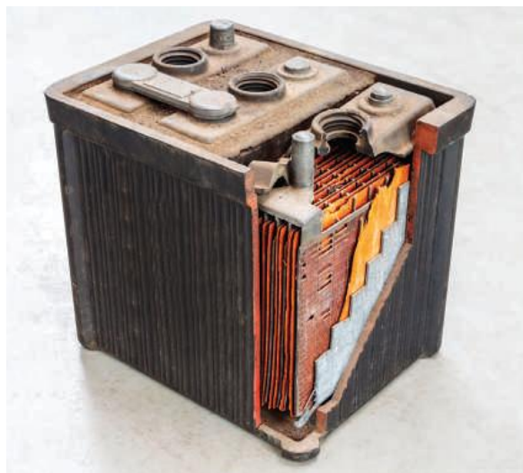
Fig. 14 Bateria de carro parcialmente aberta, mostrando as placas de Pb intercaladas com placas de PbO 2 . Há seis células em série, totalizando 12 V.
