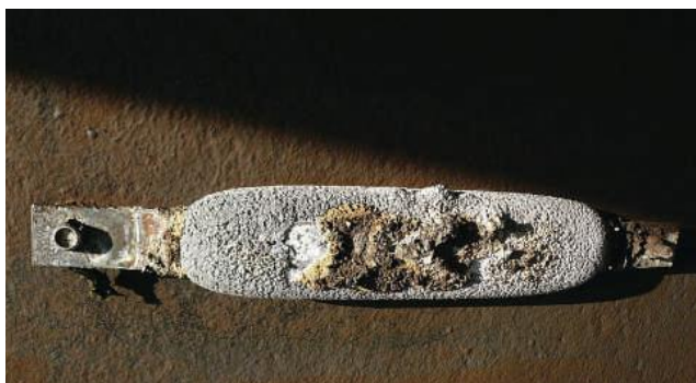
Fig. 23 Magnésio metálico parcialmente corroído, sendo utilizado como metal de sacrifício em casco de navio.
