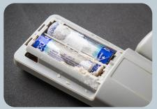
O gás presente no sistema ocasiona um aumento de pressão na pilha, levando a um possível vazamento. Sais de índio e o bismuto podem ser adicionados para minimizar as reações paralelas.
