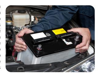
É classificada como uma bateria, pois apresenta 6 células pilhas ligadas em série, sendo cada fornecendo 2V, resultando em uma bateria comum uma ddp total de 12 V. As principais reações químicas que ocorrem são:
