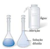
Volume incicial (V) colocado no segundo balão volumétrico é diluído com água até a aferição e então teremos um volume final (V') e uma nova concentração final (M')
