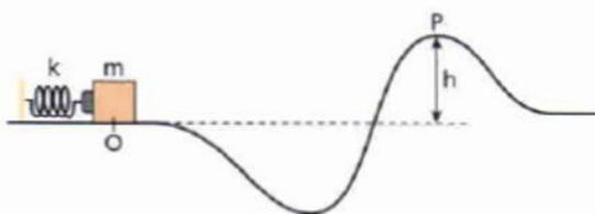
Considere que a energia potencial gravitacional seja zero na linha tracejada. O bloco, ao ser liberado, passa pelo ponto P ( $h = 0,60 \text{ m}$ ), onde 75% de sua energia mecânica é cinética. Adote  $g = 10,0 \text{ m/s}^2$  e despreze o efeito do ar.
