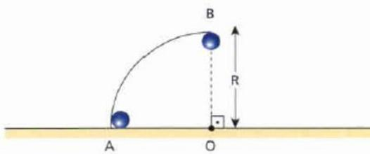
Um pequeno objeto é lançado para cima, verticalmente, a partir da base A do trilho e desliza apoiado internamente a ele, sem atrito, até o ponto B, onde escapa horizontal, caindo no ponto P do plano horizontal onde está fixado o trilho. A distância do ponto P ao ponto A é igual a  $3R$ .
