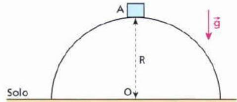
Sendo  $R$  o raio do hemisfério, calcule a que altura  $h$  do solo o bloco perde o contato com a superfície, passando a se mover sob ação exclusiva da gravidade  $\vec{g}$ .
