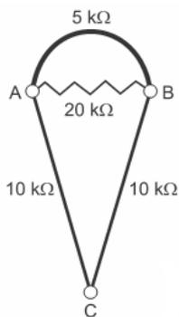
Na sequência, conectou o ohmímetro nos terminais A e B do desenho e, em seguida, conectou-o nos terminais B e C, anotando as leituras  $R_{AB}$  e  $R_{BC}$ , respectivamente. Ao estabelecer a razão  $\frac{R_{AB}}{R_{BC}}$  qual resultado o estudante obteve?
