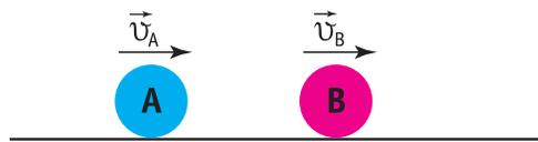
Quando as esferas A e B atingem velocidades de 8 m/s e 1 m/s, respectivamente, ocorre uma colisão perfeitamente inelástica entre ambas.
