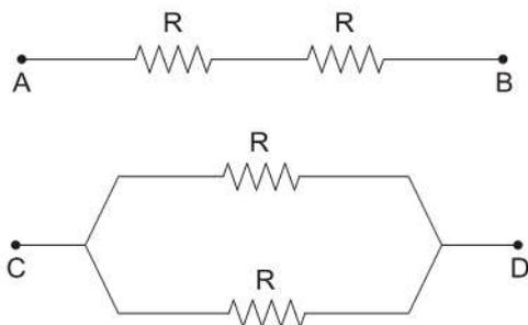
Considere que, aplicando-se uma tensão de 60 V nos seus terminais, a diferença entre as correntes totais que as percorrem seja igual a 9 A. Sendo assim, o valor de R é igual a
