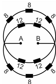
O valor da corrente elétrica da associação de resistores no circuito apresentado na figura, em ampère, é
