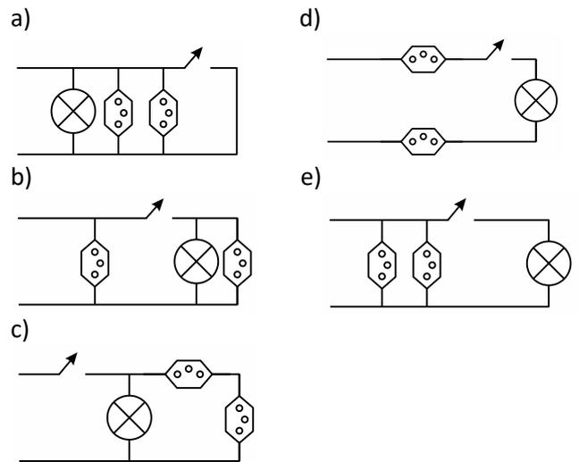
**F0626** – (Enem) Um eletricista analisa o diagrama de uma instalação elétrica residencial para planejar medições de tensão e corrente em uma cozinha. Nesse ambiente existem uma geladeira (G), uma tomada (T) e uma lâmpada (L), conforme a figura. O eletricista deseja medir a tensão elétrica aplicada à geladeira, a corrente total e a corrente na lâmpada. Para isso, ele dispõe de um voltímetro (V) e dois amperímetros (A).
