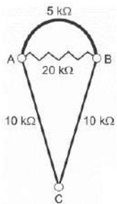
Na sequência, conectou o ohmímetro nos terminais A e B do desenho e, em seguida, conectou-o nos terminais B e C, anotando as leituras  $R_{AB}$  e  $R_{BC}$ , respectivamente. Ao estabelecer a razão  $R_{AB}/R_{BC}$  qual resultado o estudante obteve?
