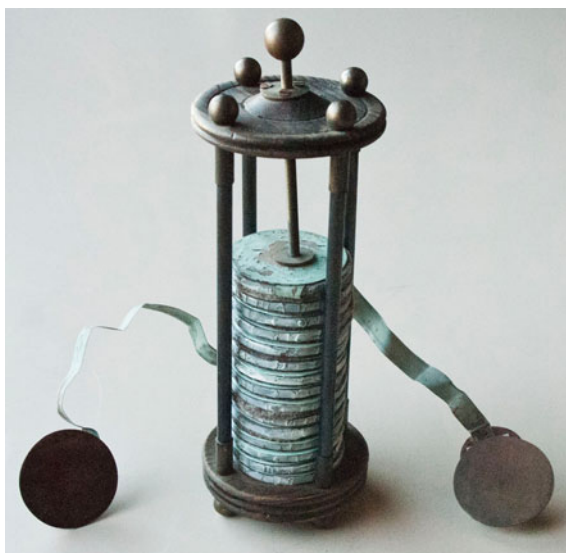
Fig. 1.8 Alessandro Volta pile (reproduction by Gelside Guatterini 1999). Museo per la Storia dell’Università—Sistema Museale di Ateneo—Pavia University
