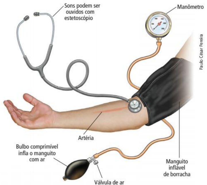
Figura 10. Para medir a pressão arterial, usa-se o esfigmomanômetro, que consiste em um manômetro (medidor de pressão) conectado a uma braçadeira inflável, de borracha, denominada manguito. (Imagem sem escala; cores-fantasia.)
