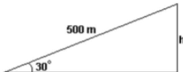
Então, depois que tiver percorrido 500 m, conforme indicado na figura, sua altura  $h$  em relação ao solo, em metros, será igual a:
