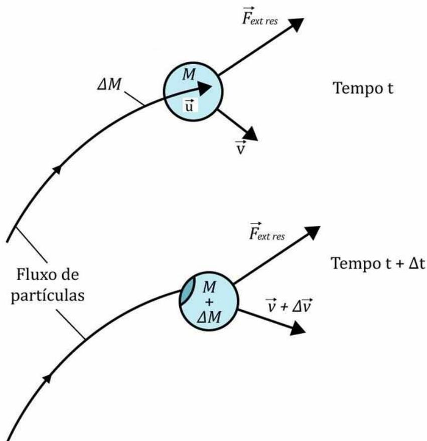
Figura 37: Partículas de um fluxo contínuo, com velocidade  $\vec{u}$ , sofrem colisões perfeitamente inelásticas com um corpo de massa  $M$  que possui velocidade  $\vec{v}$ . Nesse sistema, existe uma força externa resultante  $\vec{F}_{ext\ res}$  atuando sobre o corpo. A figura ilustra dois momentos do sistema:  $t$  e  $t + \Delta t$ .
