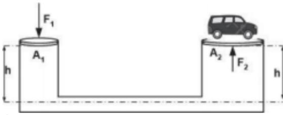
É desejável elevar veículos a velocidade constante, cuja carga máxima seja de até 4.000,0 kg. Considerando a gravidade local igual a  $10,0 \text{ m/s}^2$ , o módulo da força  $\vec{F}_1$ , em newtons, necessária para elevar esta carga máxima, vale:
