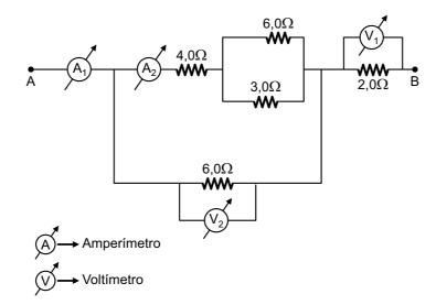
Entre os terminais **A** e **B** será ligado um gerador ideal de força eletromotriz **25,0V**. Determine:
