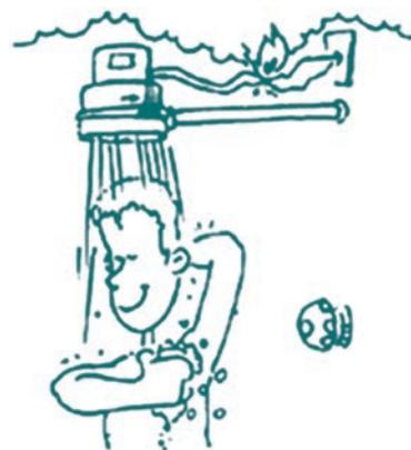
O superaquecimento da fiação, devido a esse aumento da corrente elétrica, pode ocasionar incêndios, que seriam evitados instalando-se fusíveis e disjuntores que interrompem que interrompem essa corrente, quando a mesma atinge um valor acima do especificado nesses dispositivos de proteção.
