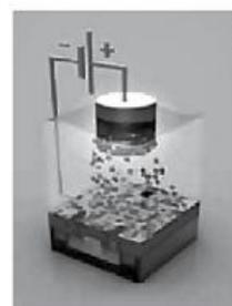
As fatias de silício são colocadas numa solução de sulfato de cobre. Nesse processo, íons de cobre deslocam-se para a superfície da fatia (cátodo), aumentando a sua condutividade elétrica.
