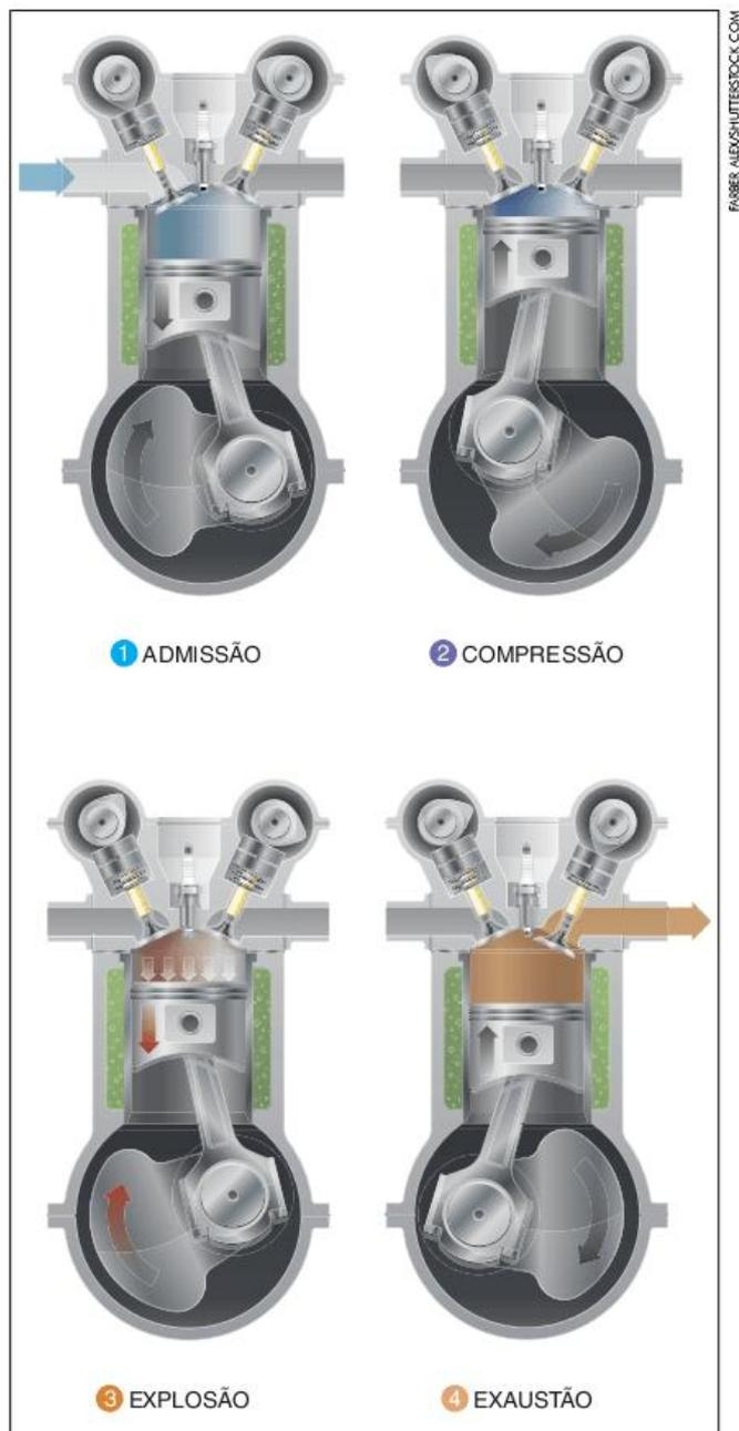
Fig. 8 Funcionamento de um motor quatro tempos.
