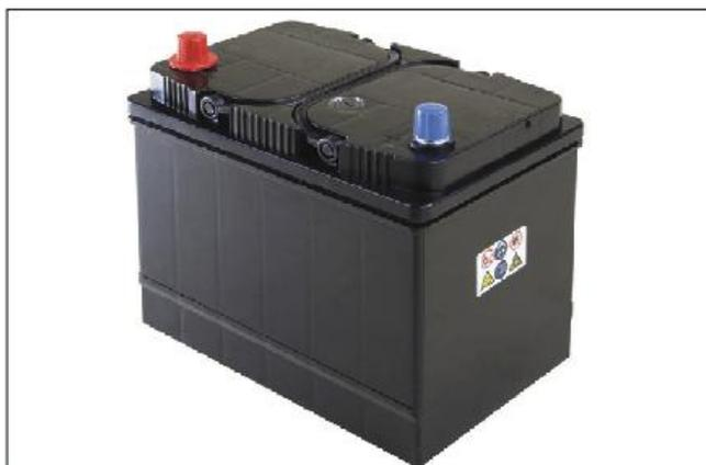
Fig. 15 Bateria de carro atual. Note como as linhas na face frontal sinalizam as seis pilhas em série que compõem o dispositivo.
