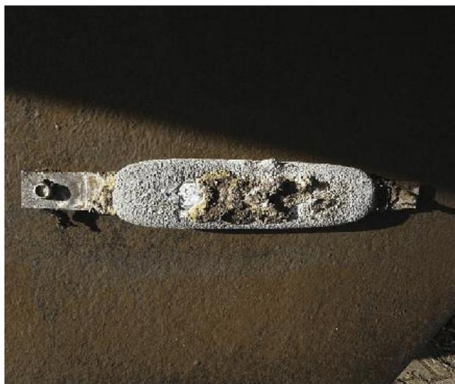
Fig. 23 Magnésio metálico parcialmente corroído, sendo utilizado como metal de sacrifício em casco de navio.
