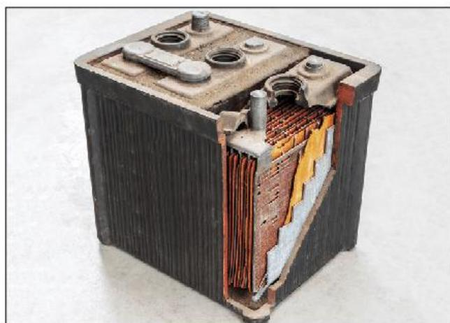
Fig. 14 Bateria de carro parcialmente aberta, mostrando as placas de Pb intercaladas com placas de  $\text{PbO}_2$ . Há seis células em série, totalizando 12 V.
