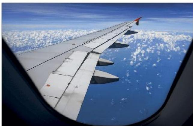
Fig. 54 Janela de avião feita de policarbonato.
