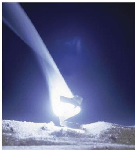
Fig. 1 Tira fina de magnésio sendo queimada, produzindo o  $\text{MgO}$  e liberando uma luz forte e bem brilhante, como em *flashes* fotográficos.
