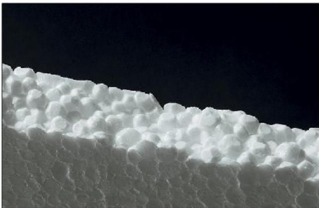
Fig. 15 Placa de isopor.
