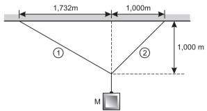
Considerando a aceleração da gravidade igual a 10 m/s<sup>2</sup>, os valores das forças de tração, em newtons, nos cabos 1 e 2 são, respectivamente:
