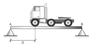
Desprezando-se o peso da viga, para que a reação vertical do apoio A seja o dobro da reação vertical no apoio B, a distância D entre o eixo dianteiro do caminhão e o apoio A deverá ser:
