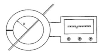
Um instrumento denominado amperímetro de alicate é capaz de medir a corrente elétrica em um ou mais condutores apenas os envolvendo com suas garras (ver figura). Quando essas são fechadas, o campo magnético produzido pelas correntes envolvidas pode ser medido por um sensor. Considere que dois condutores retilíneos, muito próximos um do outro atravessam o centro da área circular, de raio R, entre as garras do medidor. Sendo assim, o campo magnético medido pelo sensor será
