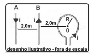
A espira e os fios são coplanares e se encontram no vácuo. Os fios "A" e "B" e a espira são percorridos por correntes elétricas de mesma intensidade i = 1 A com os sentidos representados no desenho. A intensidade do vetor indução magnética resultante originado pelas três correntes no centro "O" da espira é:
