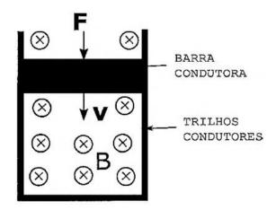
Imersa numa região onde o campo magnético tem direção vertical e módulo B=6,0~T, uma barra condutora de um metro de comprimento, resistência elétrica  $R=1,0~\Omega$  e massa m=0,2~kg desliza sem atrito apoiada sobre trilhos condutores em forma "U" dispostos horizontalmente, conforme indica a figura acima. Se uma força externa F mantém a velocidade da barra constante e de módulo v=2,0~m/s, qual o módulo da força F, em newtons?
