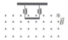
Determine a intensidade e o sentido da corrente elétrica real que se deve passar pela barra para que as molas não alterem a deformação.
