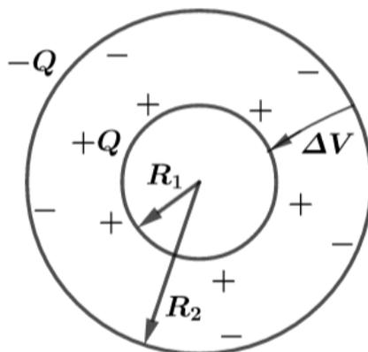
Figura 3: Capacitor esférico.
