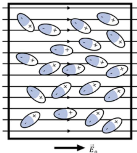
Figura 8: Moléculas polares sendo alinhadas com o campo elétrico.
