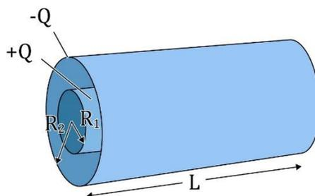
Figura 4: Capacitor cilíndrico.
