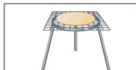
**Tela de aquecimento.** É um trançado de fios de ferro, tendo no centro um material adequado ao aquecimento. Recebendo, por baixo, o calor do bico de Bunsen, ela distribui esse calor uniformemente para os recipientes que são colocados sobre ela, evitando a quebra dos equipamentos de vidro.
