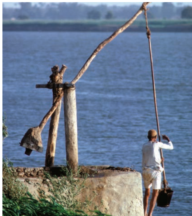
Shaduff, um antigo instrumento para obtenção de água. Egito, fotografia atual.
