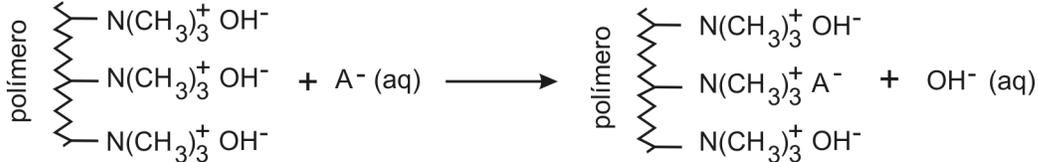
No tratamento da água com as resinas de troca iônica, a água atravessa colunas de vidro ou plástico, preenchidas com a resina sob a forma de pequenas esferas. O líquido que sai da coluna é chamado de eluído. Considere a seguinte experiência, em que água, contendo cloreto de sódio e sulfato de cobre (II) dissolvidos, atravessa uma coluna com resina do tipo I. A seguir, o eluído, assim obtido, atravessa outra coluna, desta vez preenchida com resina do tipo II.
