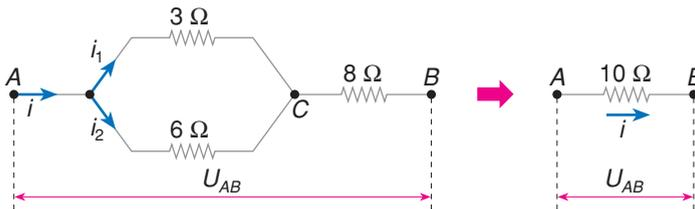
$$\begin{aligned} Pot &= R \cdot i_1^2 \Rightarrow 27 = 3 \cdot i_1^2 \Rightarrow i_1 = 3 \text{ A} \\ U_{AC} &= 3 \cdot i_1 = 6 \cdot i_2 \Rightarrow 3 \cdot 3 = 6 \cdot i_2 \Rightarrow i_2 = 1,5 \text{ A} \\ i &= i_1 + i_2 \Rightarrow i = 3 + 1,5 \Rightarrow i = 4,5 \text{ A} \\ U_{AB} &= R_{eq} \cdot i \Rightarrow U_{AB} = 10 \cdot 4,5 \Rightarrow U_{AB} = 45 \text{ V} \end{aligned}$$
