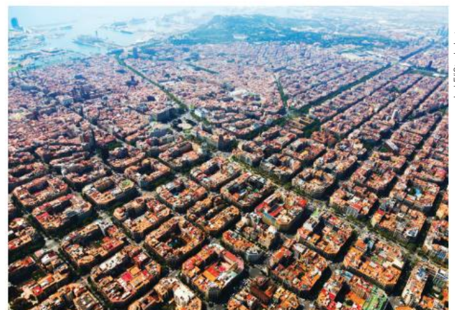
Configuração ortogonal da malha urbana de Barcelona, na Espanha, consequência da execução do Plano Cerdà, que previa, além da ampliação da área da cidade, o estabelecimento de um sistema de coleta de água, de áreas verdes nas quadras, de altura máxima das construções etc.
