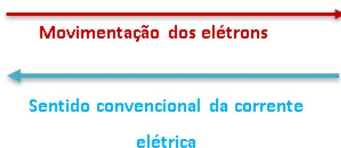
Figura 2: Sentido convencional da corrente elétrica.
