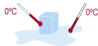
A quantidade de calor absorvida ou perdida, por unidade de massa, a uma certa pressão, sem variação de temperatura, é chamada calor latente. Matematicamente:
