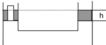
Solução:- Com o corpo está flutuando o peso  $Mg$  é igual ao empuxo  $E$ . O empuxo é igual ao peso do líquido deslocado. Desta forma:  $Mg = V \cdot \rho \cdot g \rightarrow M = (S + S - S') \cdot h \cdot \rho \rightarrow h = M/[\rho(2S - S')]$
