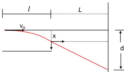
Solução:- A aceleração do elétron enquanto atravessa as placas ele sofre uma aceleração  $a = eE/m$ .
