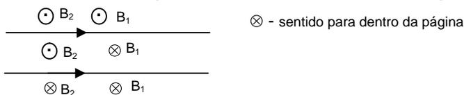
De acordo com a figura, somente entre os condutores, região II, os campos magnéticos podem se anular. Como a intensidade do campo magnético de um condutor retilíneo é  $B = Ki/d$ , teremos,  $Ki_1/x = Ki_2/(a - x) \rightarrow i_1(a - x) = i_2x \rightarrow i_1a - i_1x = i_2x \rightarrow i_1x + i_2x = i_1a \rightarrow x = i_1a/(i_1 + i_2)$ .
