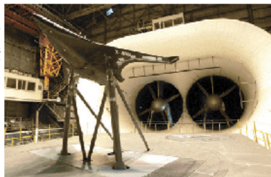
Fig. 2 Aeronave em um túnel de vento, que é utilizado para a determinação de parâmetros aerodinâmicos nos projetos de aeronaves.
