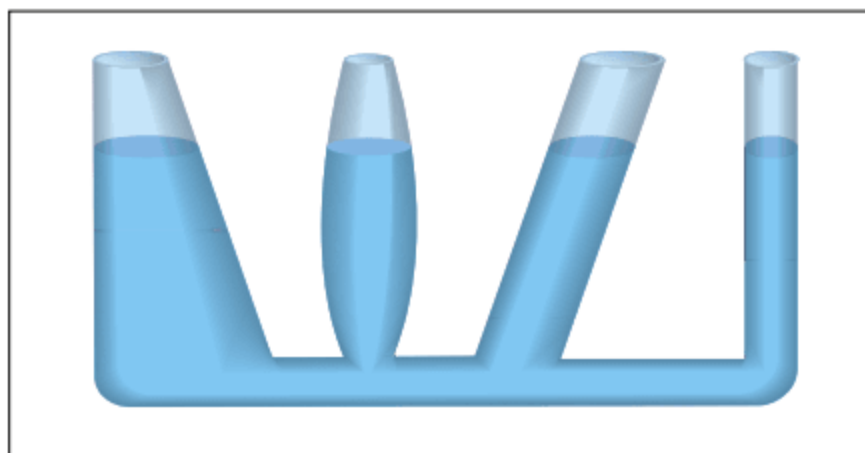
Fig. 13 A forma do recipiente não altera a pressão, pois ela depende somente da altura da coluna de líquido.
