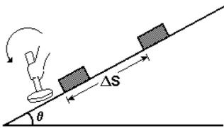
Sabendo que o coeficiente de atrito cinético entre o bloco e o plano é  $\mu_c = 0,50$  e que a aceleração da gravidade é  $g=10\text{m/s}^2$ , determine:
