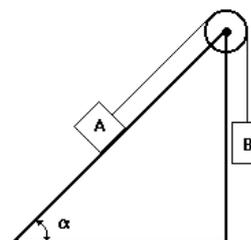
Qual será o coeficiente de atrito entre as superfícies em contacto, do corpo A com o plano, para que o corpo se desloque com movimento uniforme?
