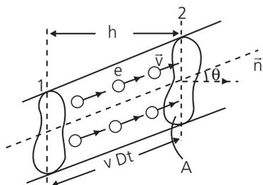
Definindo como  $\Delta t$  o tempo necessário para um portador; inicialmente na seção 1 chegar à seção 2, geramos um cilindro, de base  $A$  em altura  $h = v \Delta t \cos \theta = \vec{v} \cdot \vec{n} \Delta t$ .
