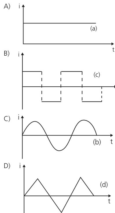
Forma de onda de uma corrente contínua (a) e corrente alternada em forma de onda harmônica (b), quadrada (C) e triangular (D)
