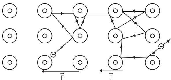
Trecho de um condutor metálico, mostrando o comportamento de um elétron livre quando há ddp aplicada. O movimento não deixa de ser caótico, mas há uma corrente elétrica média não nula no sentido do campo elétrico.
