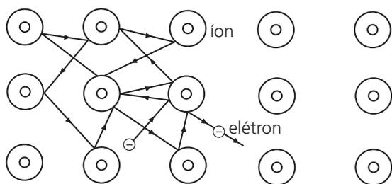
Trecho de um condutor metálico mostrando 6 comportamentos de um elétron livre quando não há ddp aplicada. O movimento é aleatório e a corrente elétrica média é nula.
