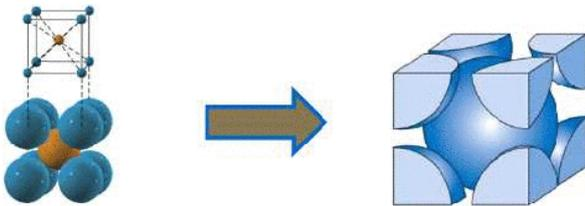
Figura 2: estrutura da célula unitária cúbica de corpo centrado (CCC).
