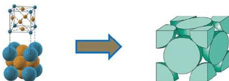
Figura 3: Estrutura da célula cúbica de face centrada (CFC).
