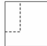
Por fim, enxergando a peça por cima, vemos, similarmente ao caso da vista frontal, uma espécie de “U” de cabeça para baixo e sem abertura, conforme a figura seguinte.
