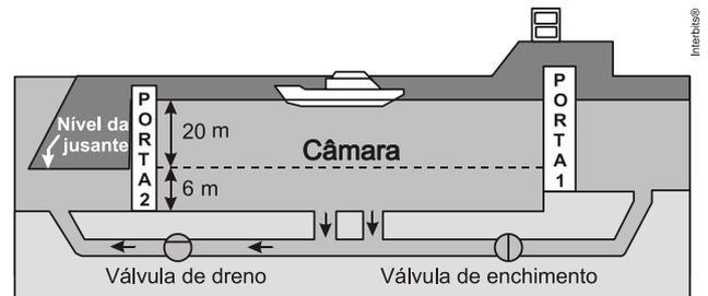
**Câmara** Enquanto a válvula de enchimento está fechada e a de dreno, aberta, o fluxo de água ocorre no sentido indicado pelas setas, esvaziando a câmara até o nível da jusante. Quando, no interior da câmara, a água atinge o nível da jusante, a porta 2 é aberta, e a embarcação pode continuar navegando rio abaixo.
