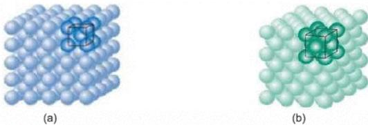
Figura 1: Agregado de muitos átomos para a estrutura cristalina: (a) cúbica de corpo centrado e (b) cúbica de face centrada.
