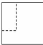
Por fim, enxergando a peça por cima, vemos, similarmente ao caso da vista frontal, uma espécie de "U" de cabeça para baixo e sem abertura, conforme a figura seguinte.
