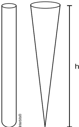
a) Sabendo que o volume de um cone de Imhoff, com raio da base igual a 2 cm, é de 60 ml, calcule a altura  $h$  desse cone.
