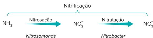
**Fig. 21** Esquema do processo de nitrificação.
