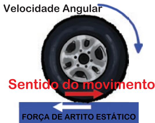
REPRESENTAÇÃO ESQUEMÁTICA DA FORÇA DE ATRITO EXERCIDA PELO CHÃO QUE NOS PERMITE CAMINHAR.
