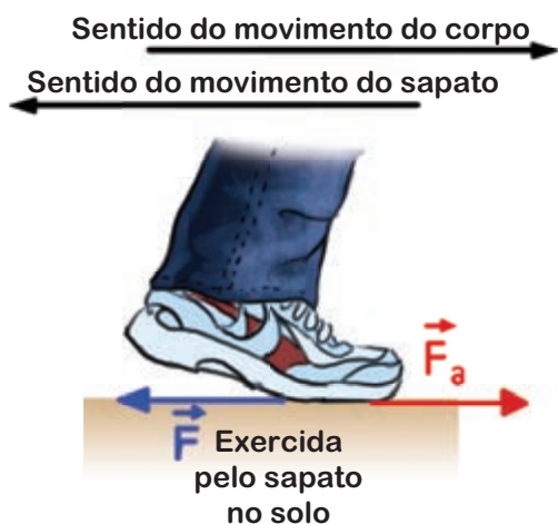
REPRESENTAÇÃO ESQUEMÁTICA DA FORÇA DE ATRITO EXERCIDA PELO CHÃO QUE NOS PERMITE CAMINHAR.
