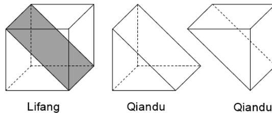
Interceptando-se o prisma *qiandu* com o plano determinado pela diagonal de uma face quadrada e a diagonal da face retangular, obtêm-se as pirâmides *yangma* e a *bienuan*.
