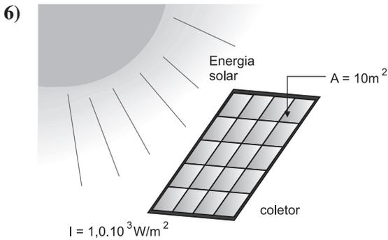
A intensidade de radiação aproveitada para o aquecimento da água ( $I_{\text{útil}}$ ) é dada por:
