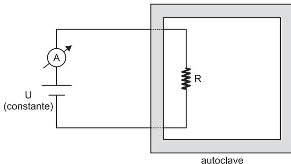
Quando o amperímetro registrar  $2,0\text{A}$ , poder-se-á concluir que a temperatura na autoclave será de:
