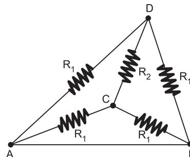
Sendo  $R_1 = 60\Omega$  e  $R_2 = 30\Omega$ , é possível afirmar que as resistências equivalentes entre os terminais C e D e A e D, valem, respectivamente:
