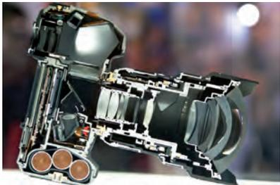
Figura 18.5: Corte transversal de uma câmera fotográfica
