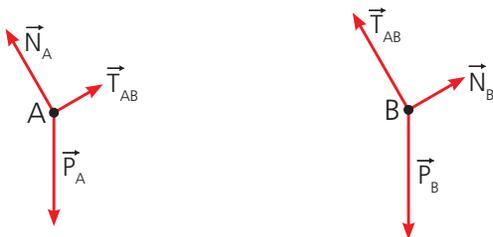
Figura 20.5: Exemplos de diagramas de corpo livre (DCL)
