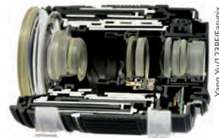
Figura 17.7: Corte transversal de uma câmera fotográfica
