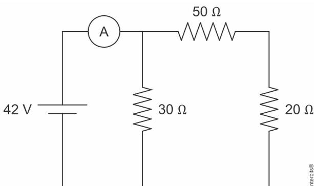
Determine o valor da intensidade da corrente elétrica, expressa em ampères, que percorre o amperímetro  $A$  conectado ao circuito elétrico.
