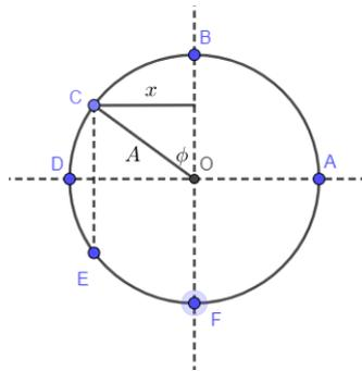
A projeção do pêndulo sai de A, percorre o arco AB em um intervalo de tempo igual a 1/4 do período normal (caso não houvesse a parede); percorre BC em um intervalo de tempo t, onde o pêndulo bate elasticamente com a parede; percorre EF em um intervalo de tempo t; percorre FA em um 1/4 do período normal. Assim:
