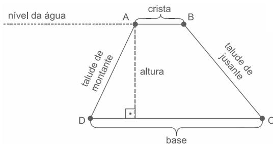
Um corte vertical de uma barragem é um modelo matemático
