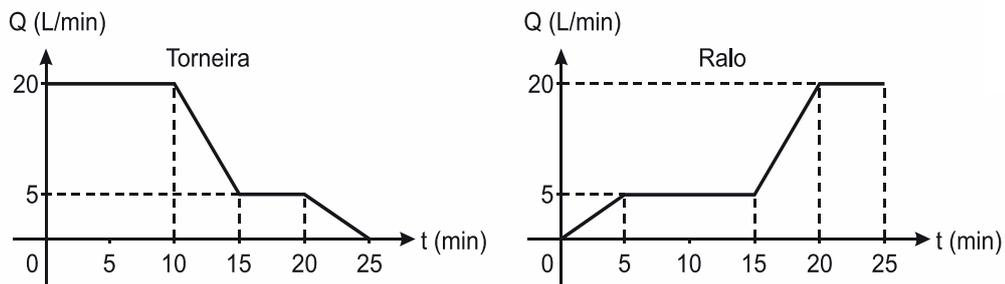
Em qual intervalo de tempo, em minuto, o reservatório tem uma vazão constante de enchimento?
