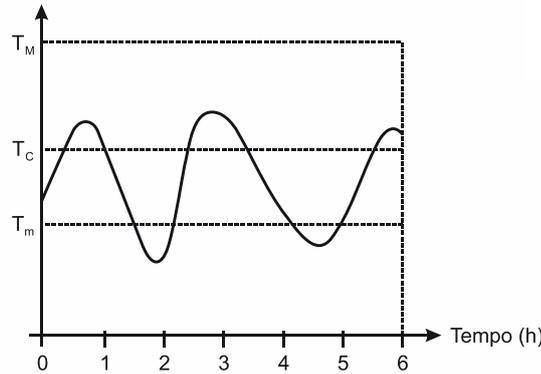
Quantas foram as vezes que o sensor de temperatura acionou o sistema, ligando-o ou desligando-o?
