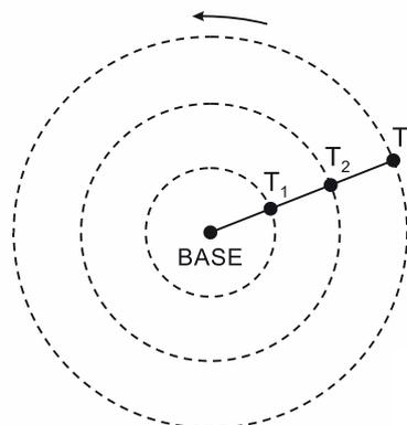
Um pivô de três torres  $T_1$ ,  $T_2$  e  $T_3$  será instalado em uma fazenda, sendo que as distâncias entre torres consecutivas bem como da base à torre  $T_1$  são iguais a 50 m.
