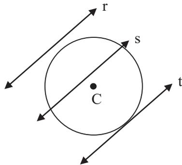
$$\begin{cases} d(C, r) > R \Rightarrow r \text{ é exterior } (\Delta < 0) \\ d(C, s) < R \Rightarrow s \text{ é secante } (\Delta > 0) \\ d(C, t) = R \Rightarrow t \text{ é tangente } (\Delta = 0) \end{cases}$$
