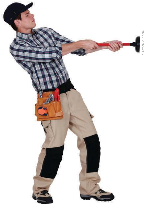
Fig. 8 A diferença entre as pressões externa e interna que atuam no desentupidor faz com que ele permaneça fixo à parede.
