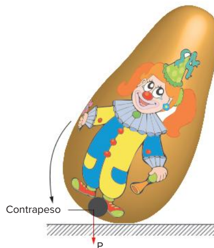
Fig. 41 O brinquedo joão-bobo, ou joão-teimoso, se caracteriza por um equilíbrio estável, já que o contrapeso em sua base dá origem a um torque de restauração.
