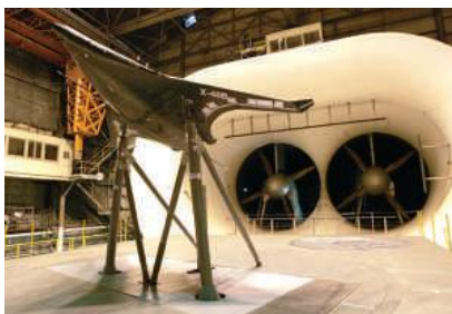
Fig. 2 Aeronave em um túnel de vento, que é utilizado para a determinação de parâmetros aerodinâmicos nos projetos de aeronaves.
