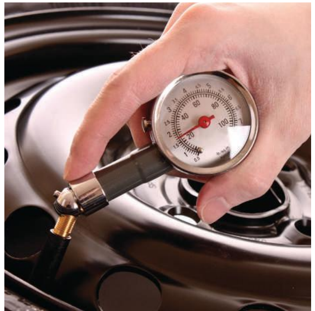
Fig 7 Na calibragem de pneus, a pressão utilizada é a manométrica
