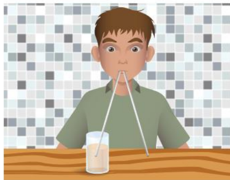
Fig. 10 Ao utilizarmos dois canudos, um dentro do copo, em contato com o líquido, e outro fora do copo, não conseguimos sugar o líquido, já que fica impossível criar a diferença de pressão. Na boca, teríamos sempre ar com pressão atmosférica por causa do canudo que está fora do copo.
