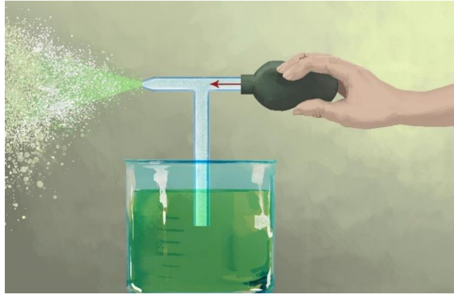
Figura 53: Esquema simples de um vaporizador manual.
