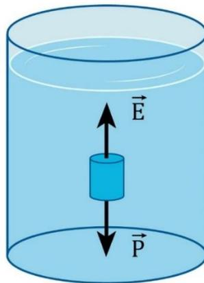
A força resultante, chamada de força ascensional, se dará pela diferença entre a força de empuxo e a força peso:
