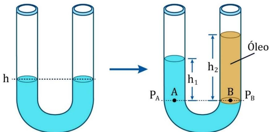
Figura 09.5 – Óleo adicionado em um tubo em U em equilíbrio que antes só continha água.
