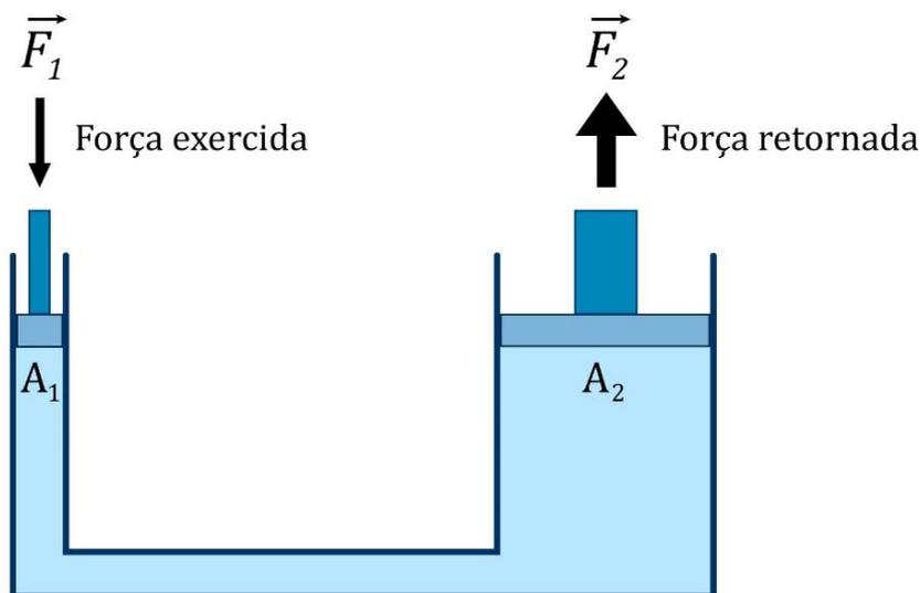
Figura 09.6 – Esquema de uma prensa hidráulica simples.
