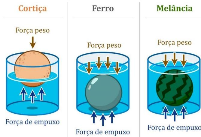
Figura 09.7 – Corpos de diferentes massas específicas em contato com a água.
